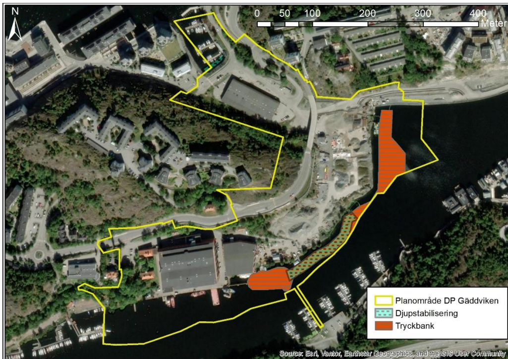
Figur 4-14 Bild över planområdet med föreslagna stabilitetshöjande åtgärder.
